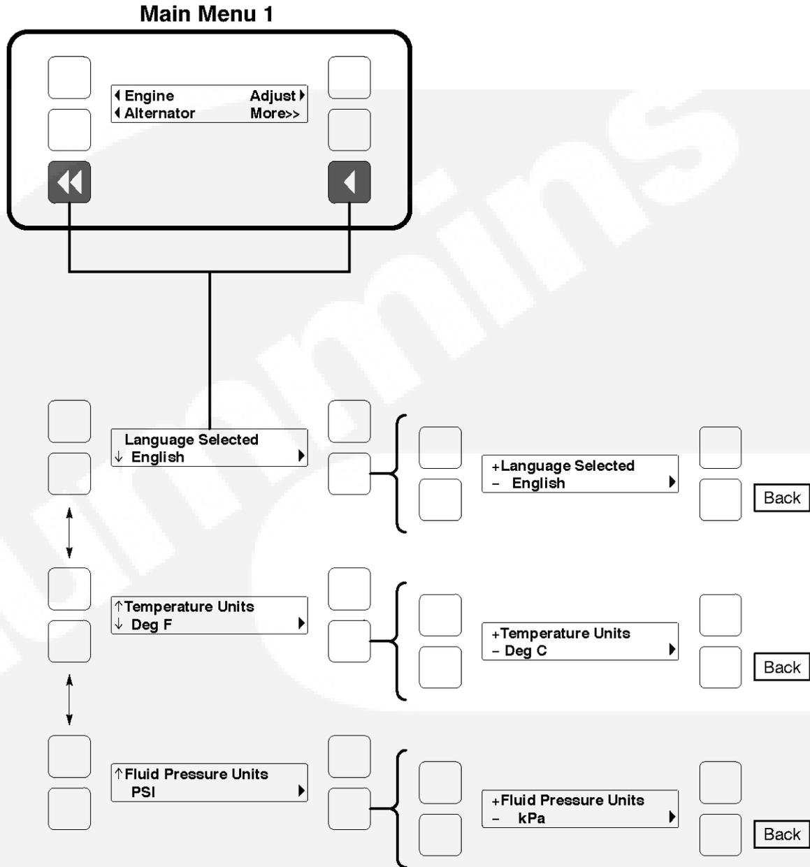
FIGURE 16. CONTROLLER CONFIGURATION MENU
