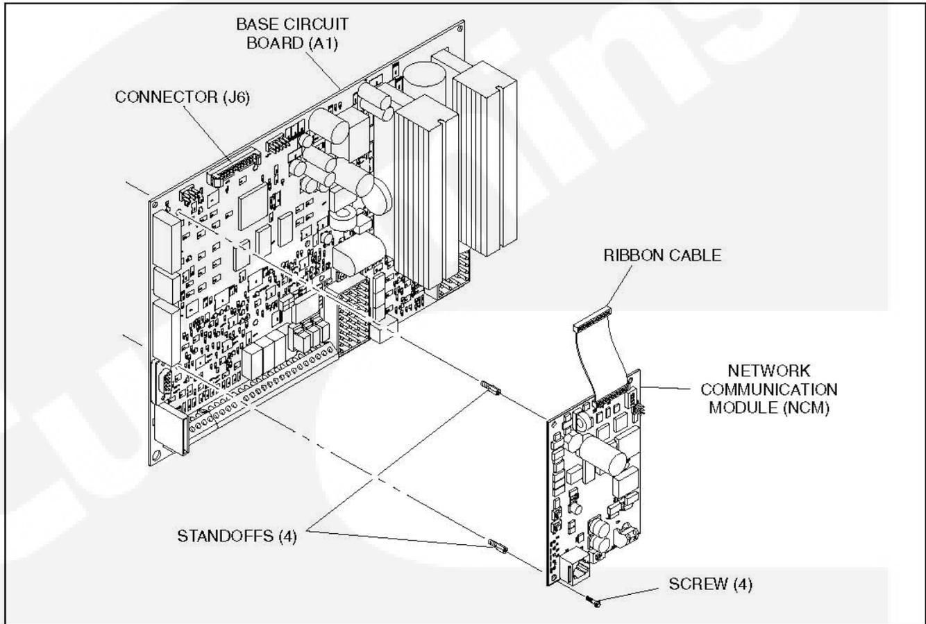
FIGURE 30. NETWORK COMMUNICATION MODULE
