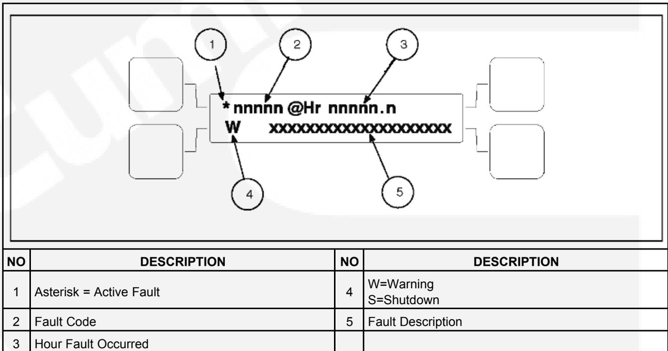
FIGURE 21. HISTORY/CURRENT FAULT SUBMENU
