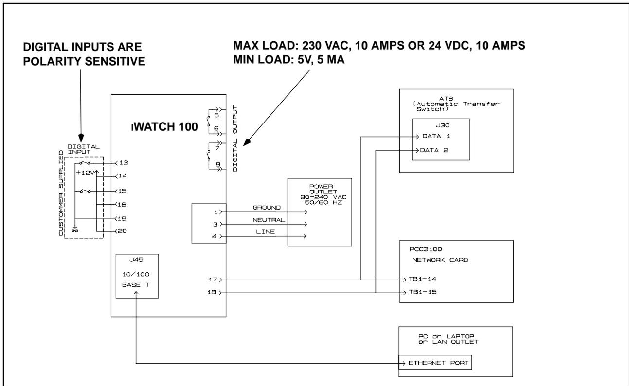
**FIGURE 3-8. POWERCOMMAND iWATCH 100 WITH POWERCOMMAND 3100 CONTROL**
