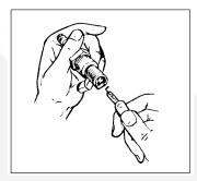
FIGURE 26. GAPING SPARK PLUG
