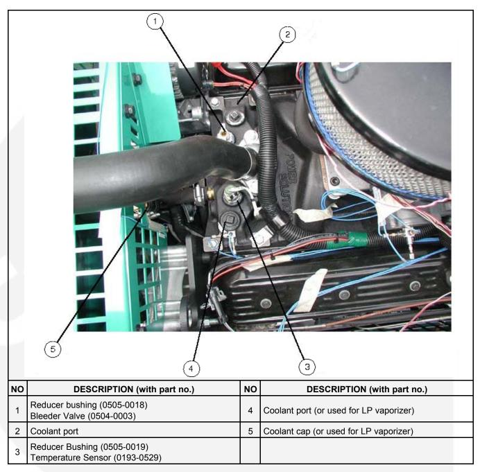
FIGURE 17. ENGINE COOLANT PORTS - LOCATION A
