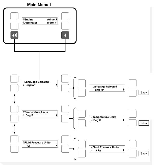
FIGURE 5. CONTROLLER CONFIGURATION MENU
