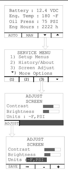
FIGURE 10. BRIGHTNESS AND CONTRAST SCREEN NAVIGATION
