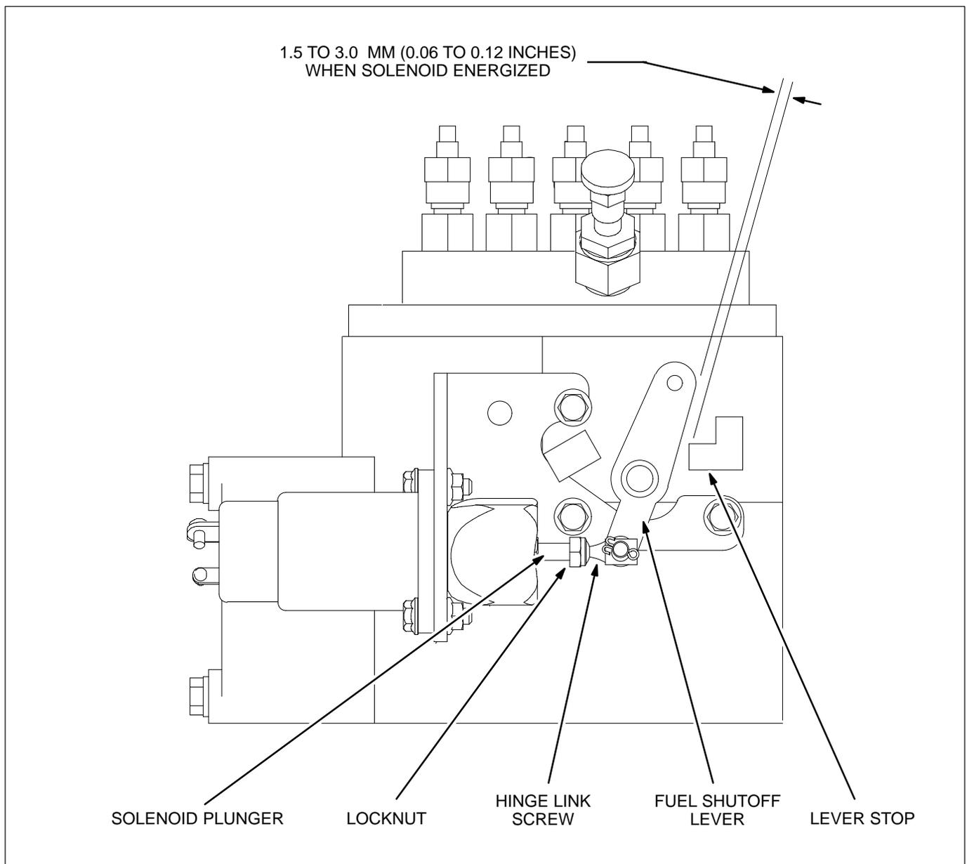
FIGURE 8-2. FUEL SHUTOFF LEVER ADJUSTMENT
