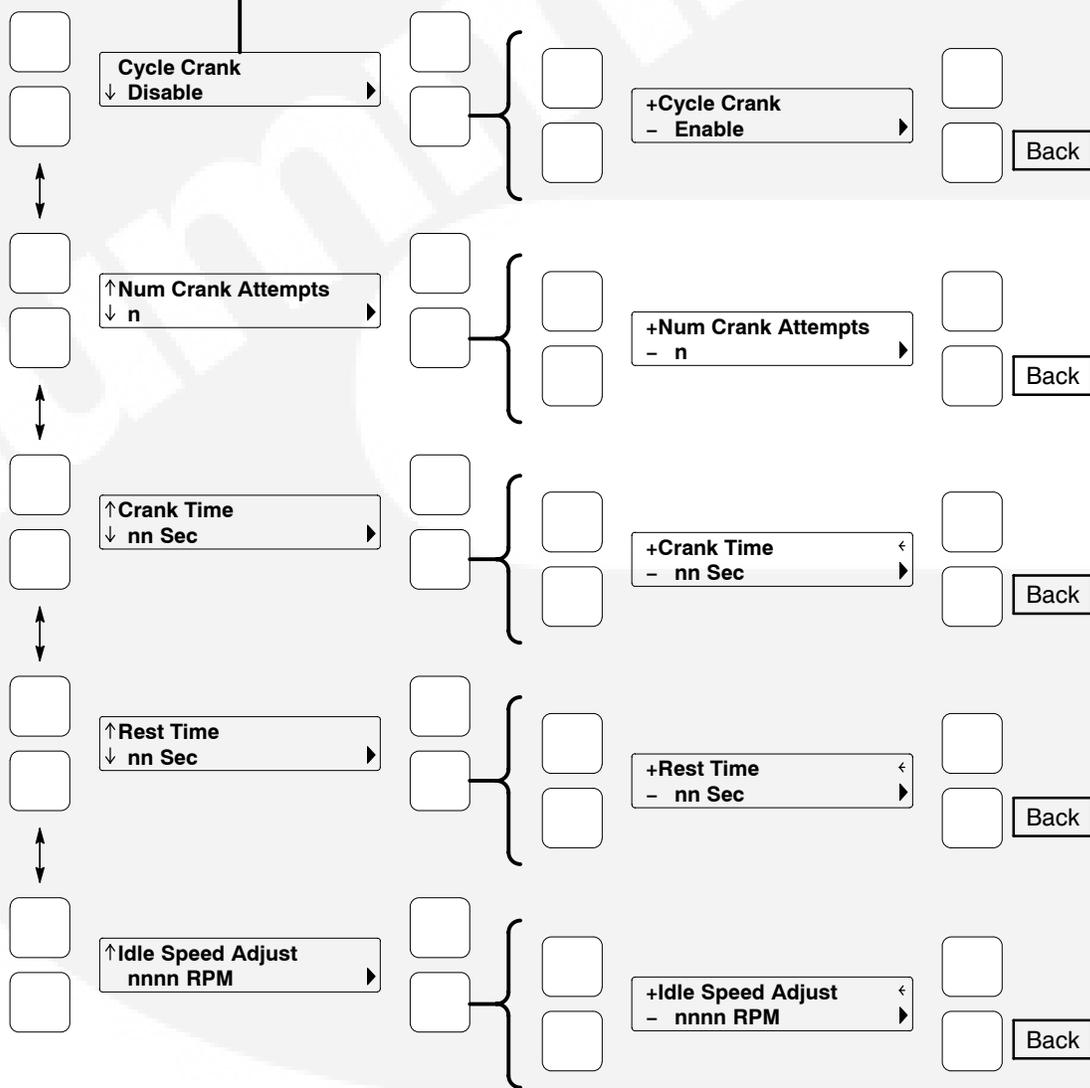
FIGURE 5-3. CRANK/IDLE SETUP MENU
