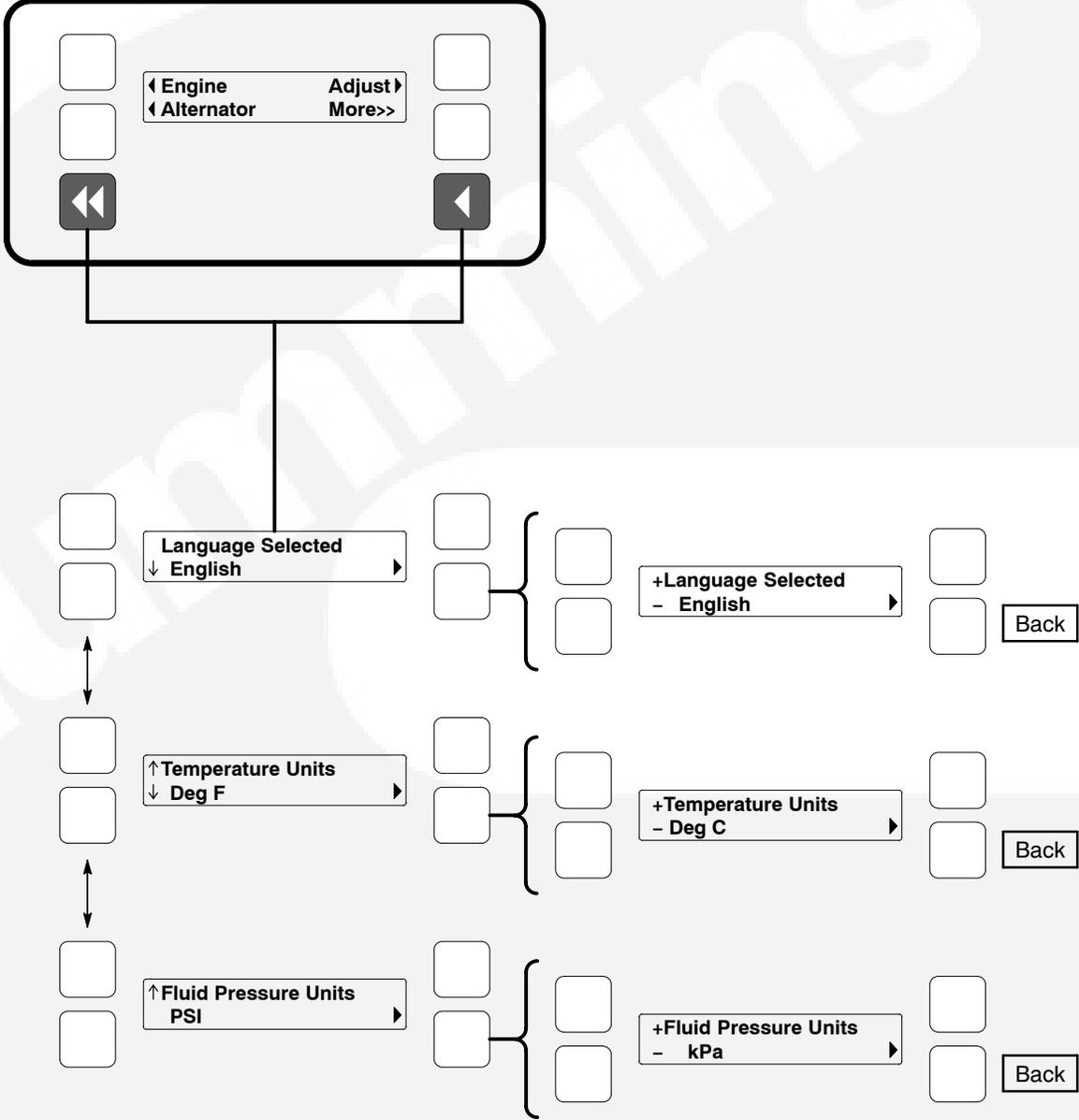
FIGURE 2-4. CONTROLLER CONFIGURATION MENU
