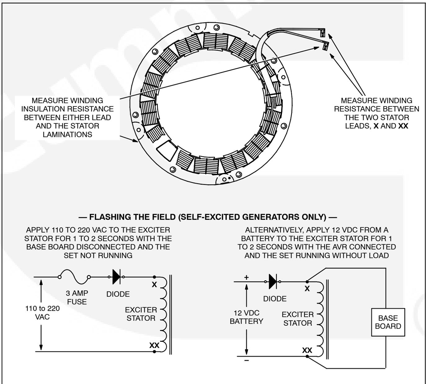
FIGURE 6-2. TESTING AND FLASHING THE EXCITER STATOR
