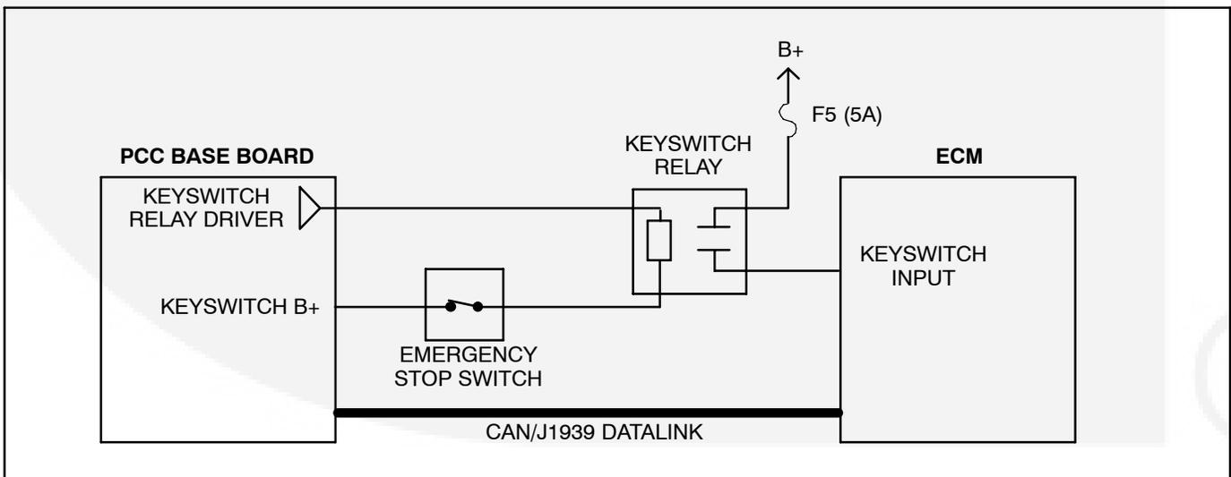
FIGURE 3-3. CONTROL SYSTEM BLOCK DIAGRAM
