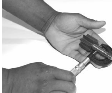
Checking Shaft OD
