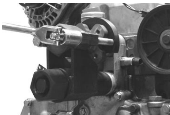
Removing Fan Hub Assembly
