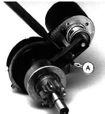
Remove Pivot Pin
