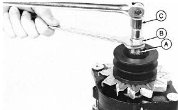
Remove Pulley Nut
