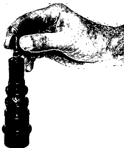
Fig. 2-5. (F60194). Remove the cup
