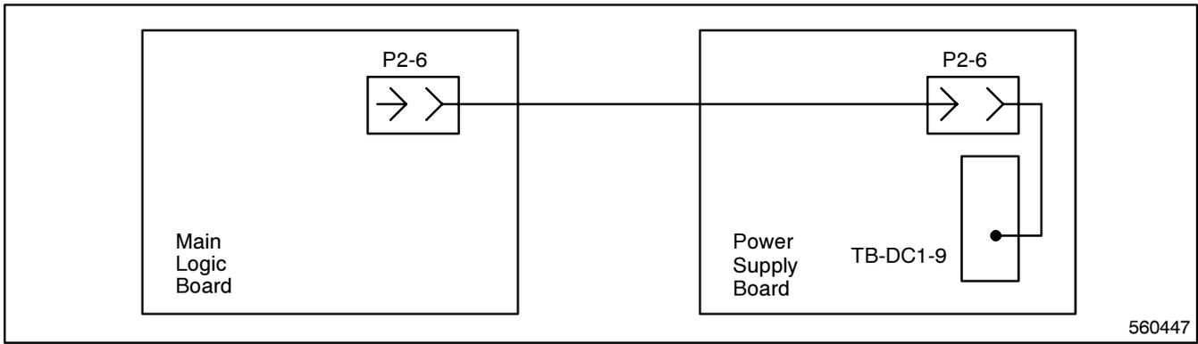
Figure 4-7. Wiring Diagram—System-Status, Not-In-Automatic LED
