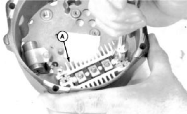
Install Rectifier Bridge
