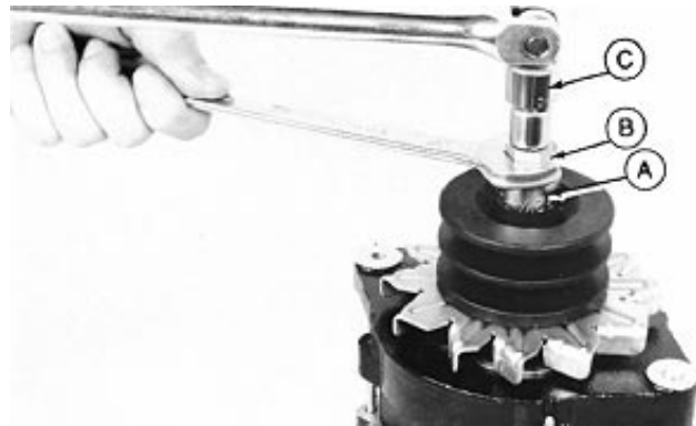
Remove Pulley Nut
