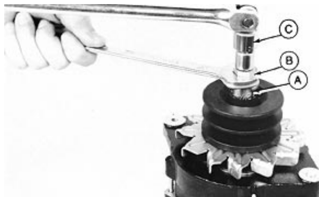
Remove Pulley Nut
