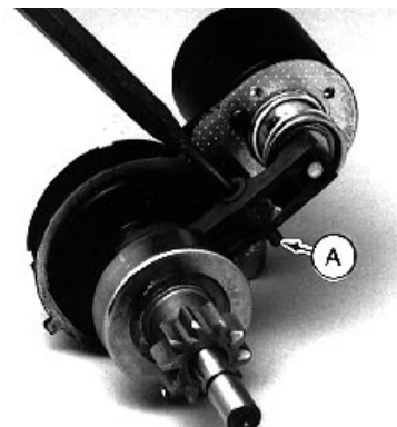
Remove Pivot Pin
